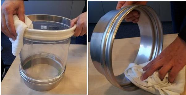
Zur Reinigung die Verbindung aus der Muffe nehmen. Hierzu keine scharfen oder spitzen Werkzeuge verwenden sondern die Verbindung per Hand oder mit dem dafür vorgesehenen TR Werkzeug aus der Muffe lösen. Dann die Verbindung innen und außen sowie rund um die Dichtungsringe nach Bedarf trocken oder nass reinigen. Das innere Ringprofil der Metallmuffen ebenfalls reinigen vor dem Wiedereinsetzen der Verbindung
