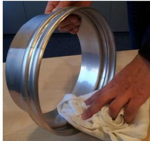
Zur Reinigung die Verbindung aus der Muffe nehmen. Hierzu keine scharfen oder spitzen Werkzeuge verwenden sondern die Verbindung per Hand oder mit dem dafür vorgesehenen TR Werkzeug aus der Muffe lösen. Das innere Ringprofil der Metallmuffen ebenfalls reinigen vor dem Wiedereinsetzen der Verbindung.
